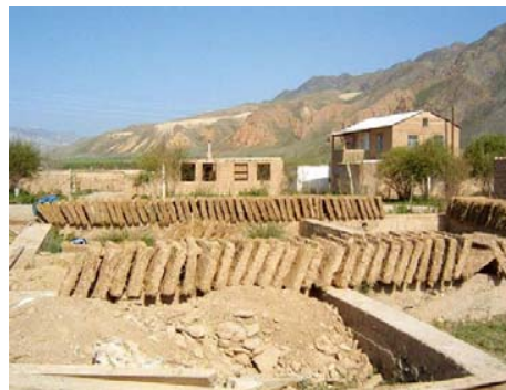
на фото: сушка глиняно-соломенной массы
